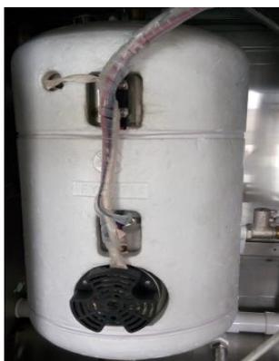
**水胆：**水胆采用食品级 304 不锈钢板制作，采用加厚 30mm 新型阻燃保温层，节能安全。内胆采用的是行业最先进的滚焊技术，保证在焊接时达到无漏焊无裂缝，并且能准确控制电流大小，不破坏焊接处内结构元素，从而达到承压力强，无焊缝腐蚀及超长的使用寿命。采用常压式设计，特有专利技术，在温开水出水口设有单向泄压阀和自来水进水口连接，加热时热水胆压力膨胀，经过温开水流入自来水进水口，通过压力差，开水胆压力自然泄出，与自来水压力保持一致，保持常压状态。智能控制、自动补水、安全泄压，管道内胆全密封装置，避免二次污染。直流弱电控制线路，产品配备有防漏电、干烧、热罐、爆裂、蒸汽、缺水、超温保护装置。
