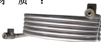
高效热能交换器，外管 1.2mm304 不锈钢硬管，内管 1.0mm304 螺纹管，排水系统用内带钢丝耐高温塑料软管，确保排水系统不漏水，不易损坏，经久耐用。
