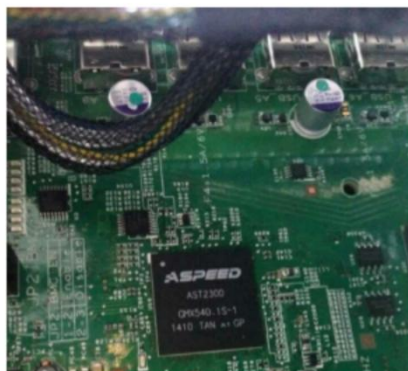
有漏洞的ASPEED BMC管理芯片
