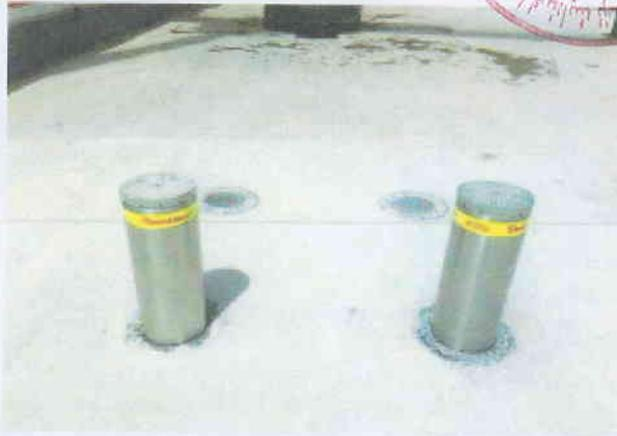
图一：LZDZ-D1-HLZ505-10 型防暴升降式阻车路障碰撞前路障状态
