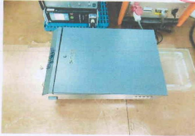
图九：浪涌（冲击）抗扰度和电快速瞬变脉冲群抗扰度试验检测布置图
