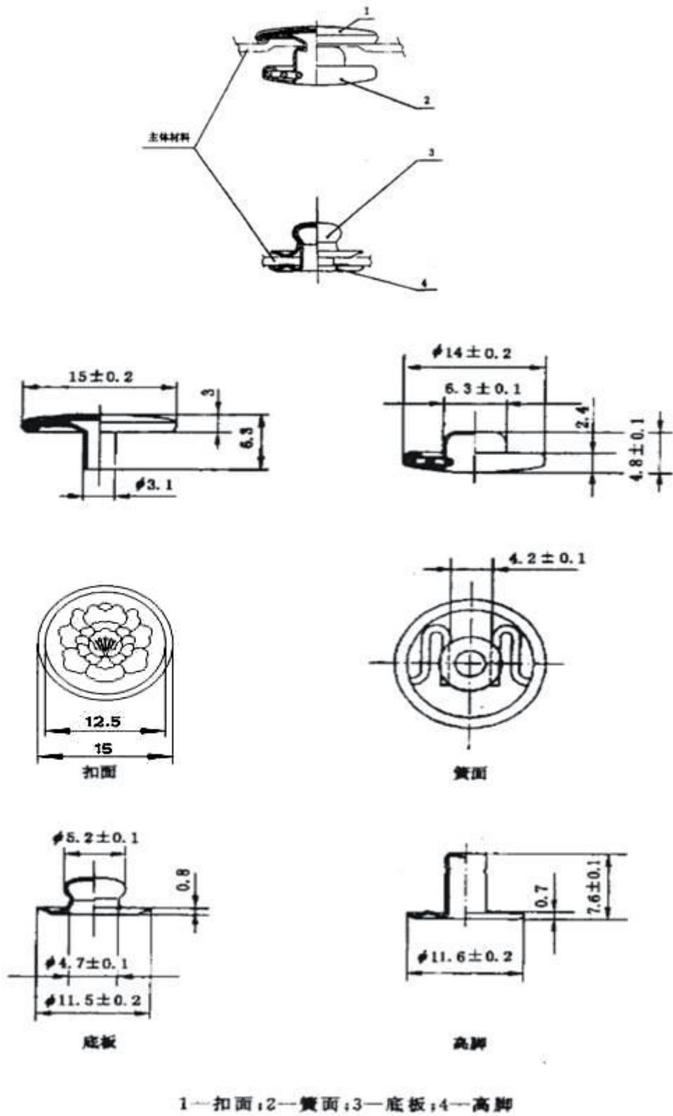
图 72 四件扣外观式样和结构尺寸
