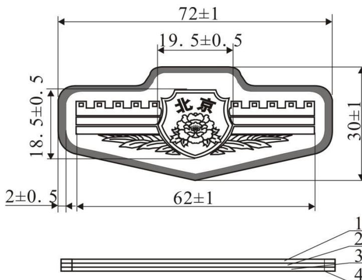
1-涤纶低弹丝电脑织绣片;2-热熔胶片;3-搭扣带(勾面);4-涤纶弹力丝包边线
