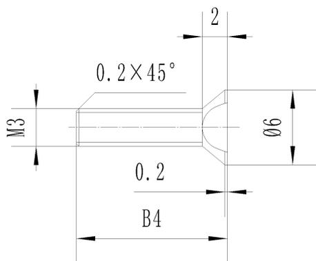
图 53b 螺钉结构及主要尺寸
