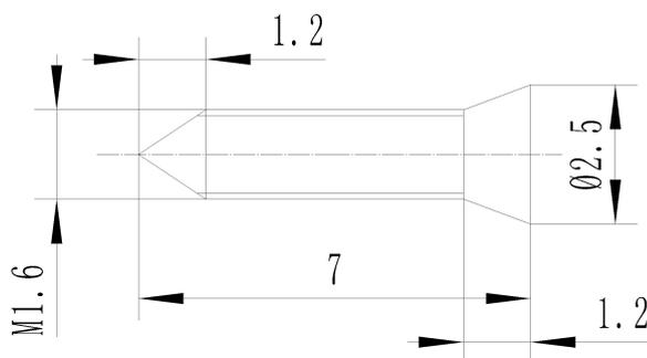
图59b 螺钉结构及主要尺寸
