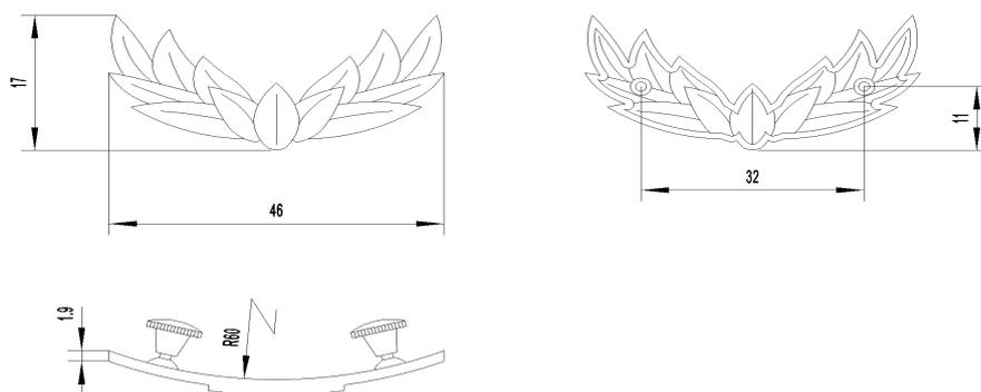
图 55b 金属橄榄枝结构尺寸
