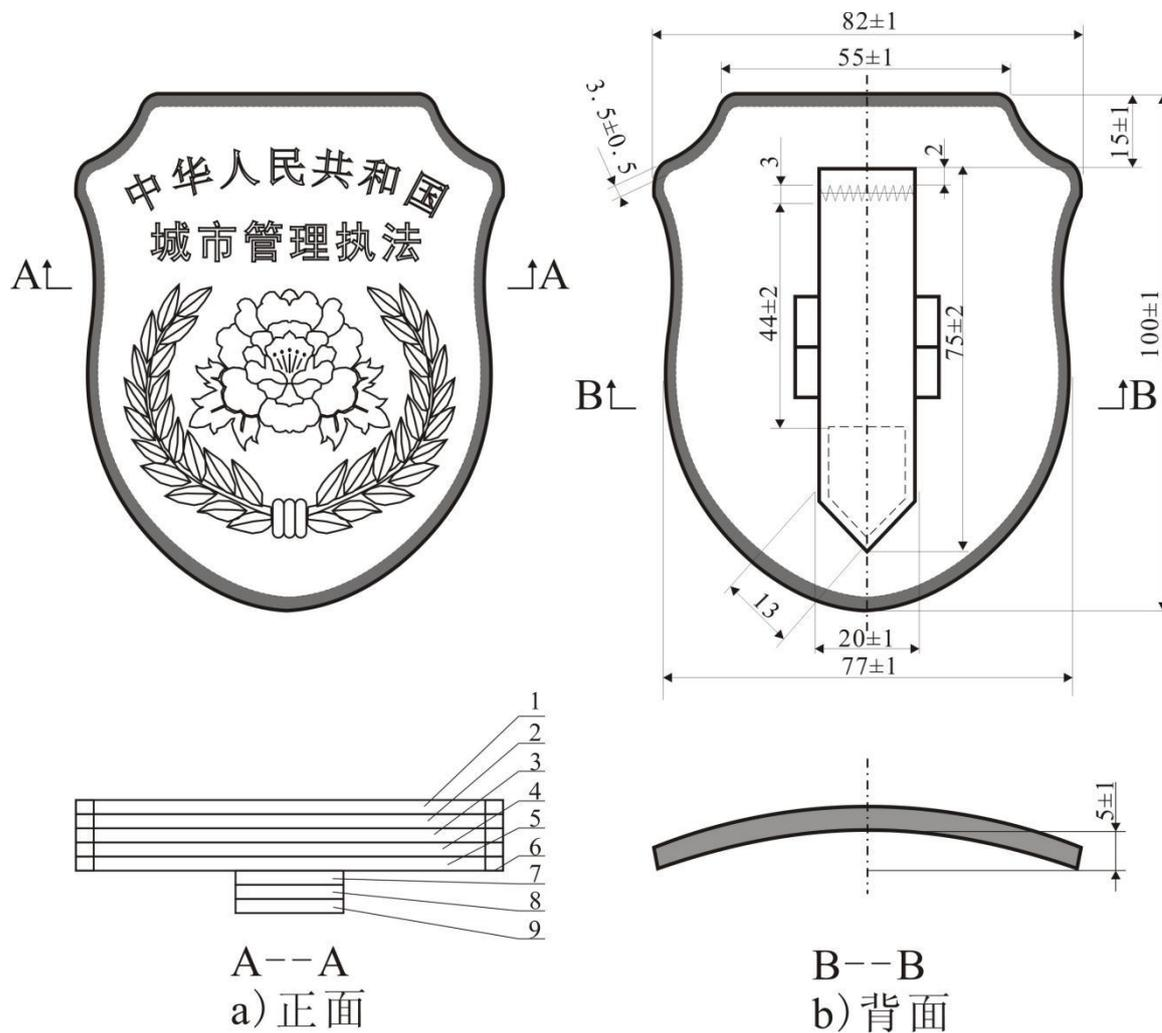
1—涤纶低弹丝电脑提花织片；2—热熔胶片（厚）；3—热塑性TPE复合材料衬板；4—热熔胶片（薄）；
