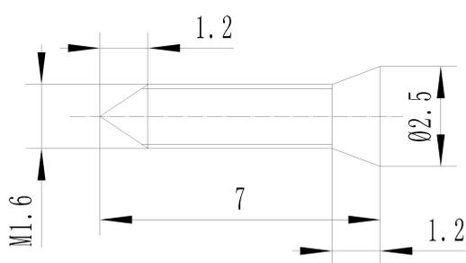
图 61b 螺钉结构及主要尺寸
