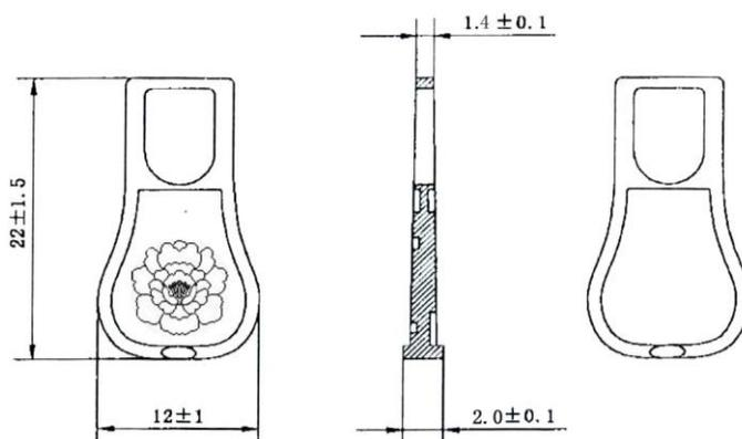
图 80 5 号注塑拉链的拉片样式
