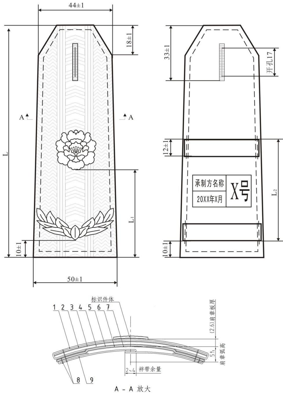
1—涤纶低弹丝提花丝织布；2—树脂粘合衬；3—热熔胶片；4—塑料衬板；
