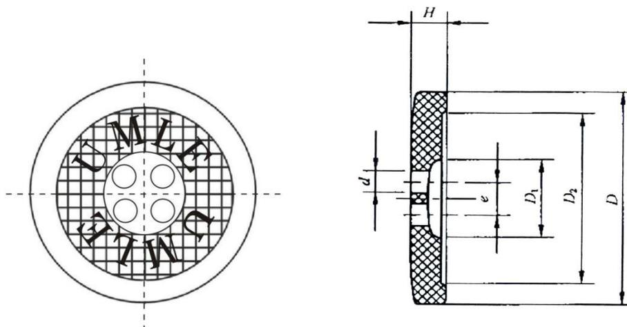
图 69 I类钮扣外观式样和结构尺寸
