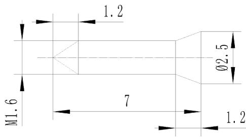
图 63b 螺钉结构及主要尺寸
