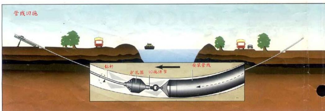
地下孔经过预扩孔，达到了回拖要求之后，将钻杆、扩孔器、回拖活节和被安装管线依次连接好，从出土点开始，一边扩孔一边将管线回拖至入土点为止。
