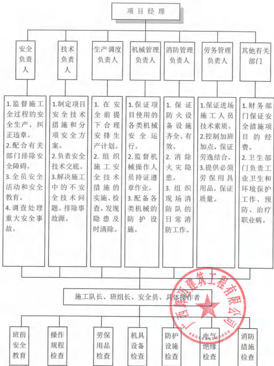
图 2-2 施工项目安全责任体系
