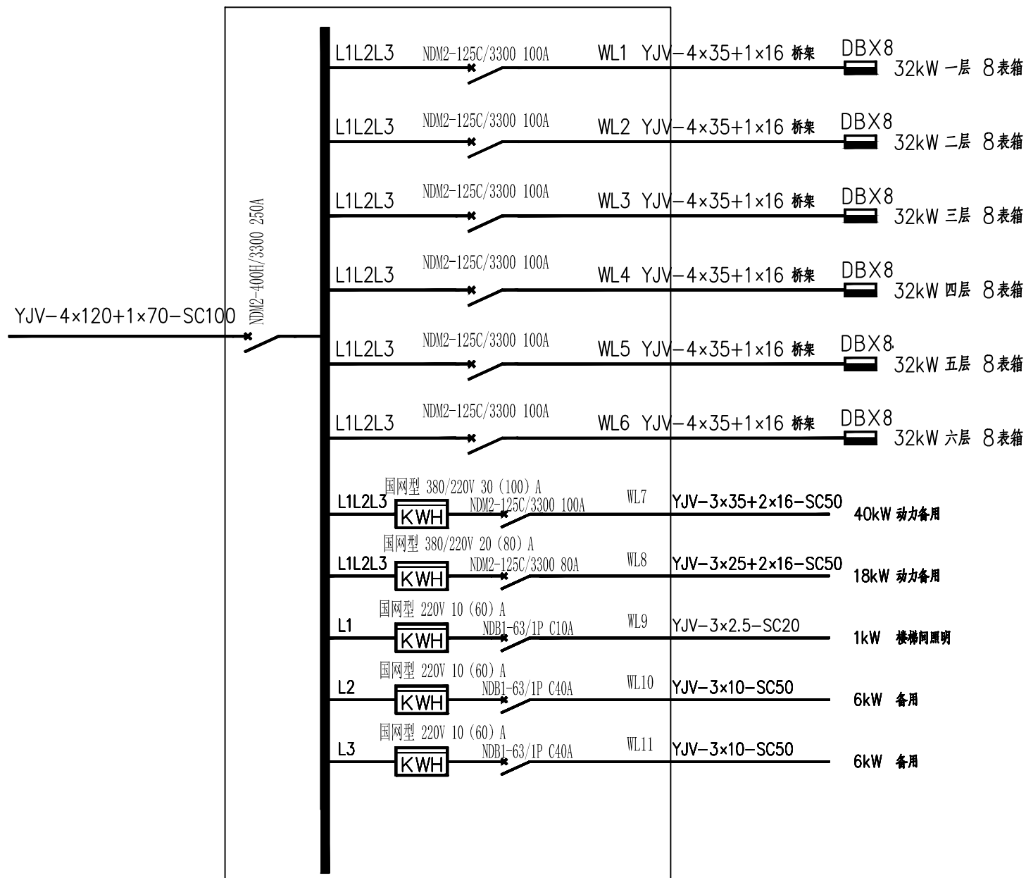
宿舍单元底层总开关箱DZKX66系统图
