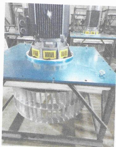
5、风机安装形式：采用整体安装式，从箱内可直接吊出，可在二十分钟内完成故障风机的更换。这种可在线维修方式，避免了因风机故障中途停机检修所带来的电能、时间及工件的损失。
