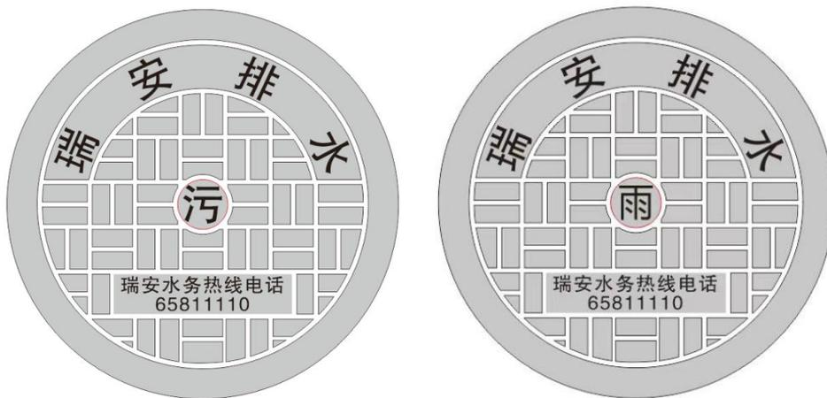
注: ①井盖表面应光洁、平整、无裂缝, 防滑花纹、图案和标记应清晰。
