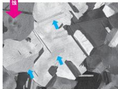
高角度刻蚀的铜板的背散射电子像 再进行高角度平面刻蚀, 如 \Rightarrow 所示, 出现了很多因晶体取向形成的凹凸。
