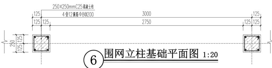
6 围网立柱基础平面图 1:20
