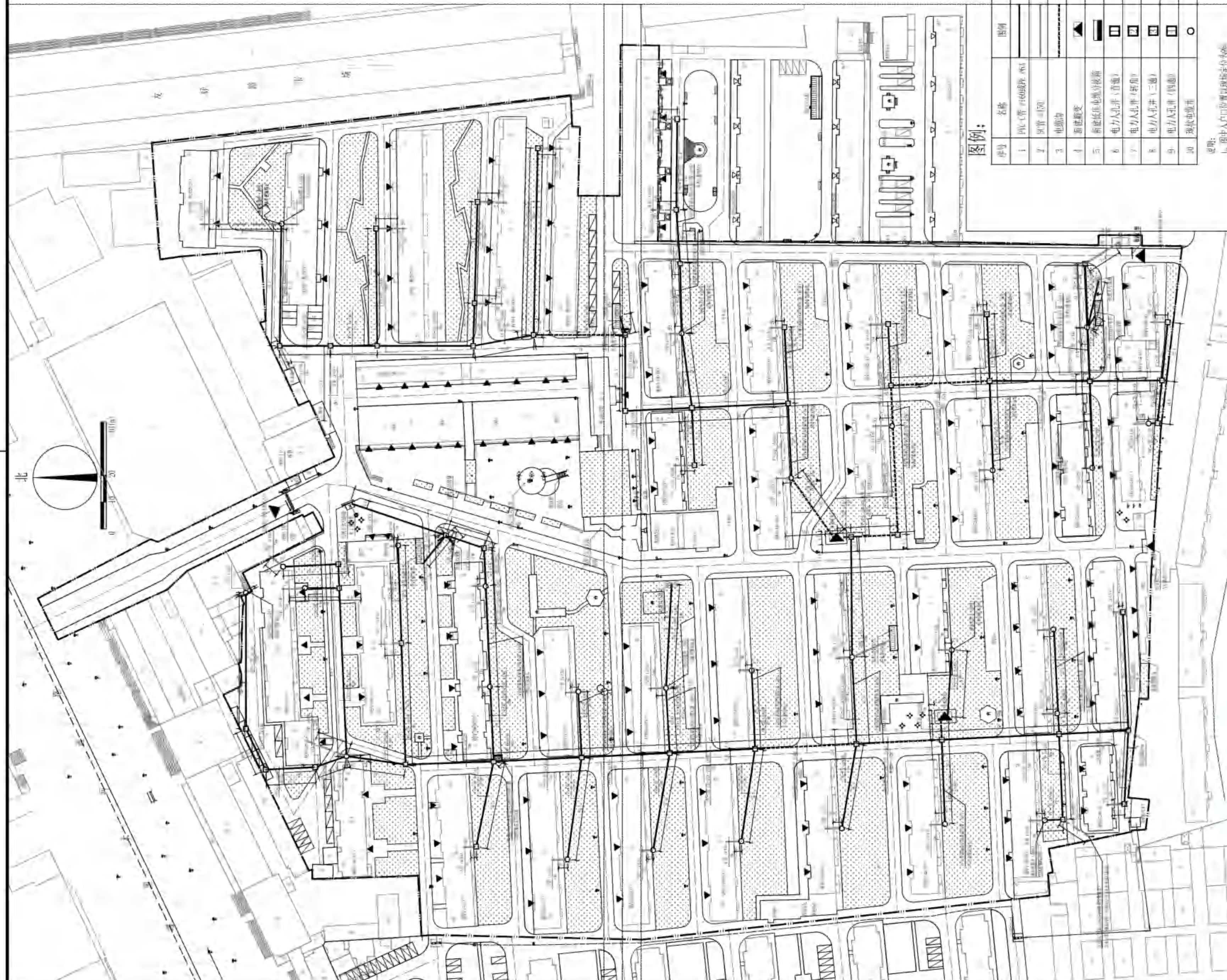
改造后电力管网预埋套管布置图 1:1000
