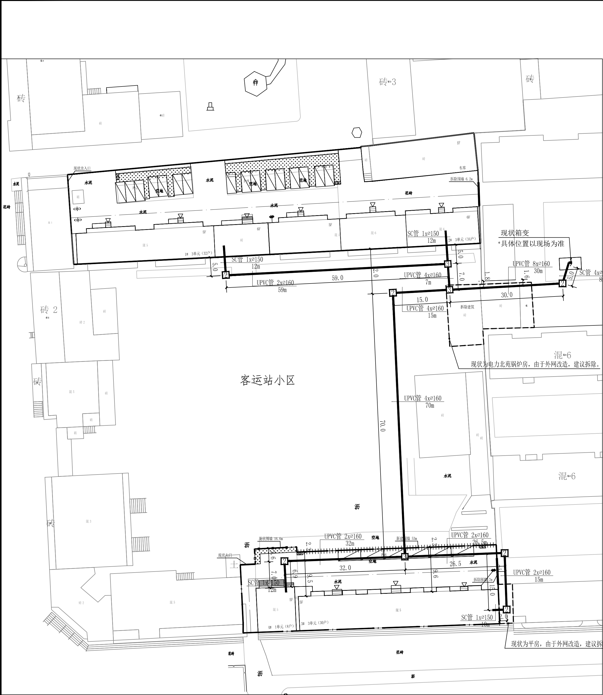
改造后电力管网预埋套管布置图 1:500
