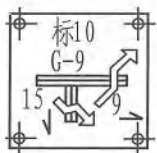
电缆壕沟分支
