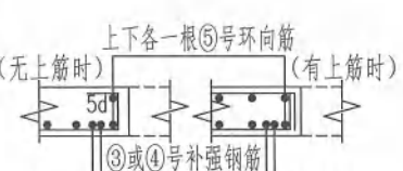
注：洞边补强钢筋由遇洞口被切断的板上部钢筋或板下部钢筋的弯钩固定。 洞边被切断钢筋端部构造
