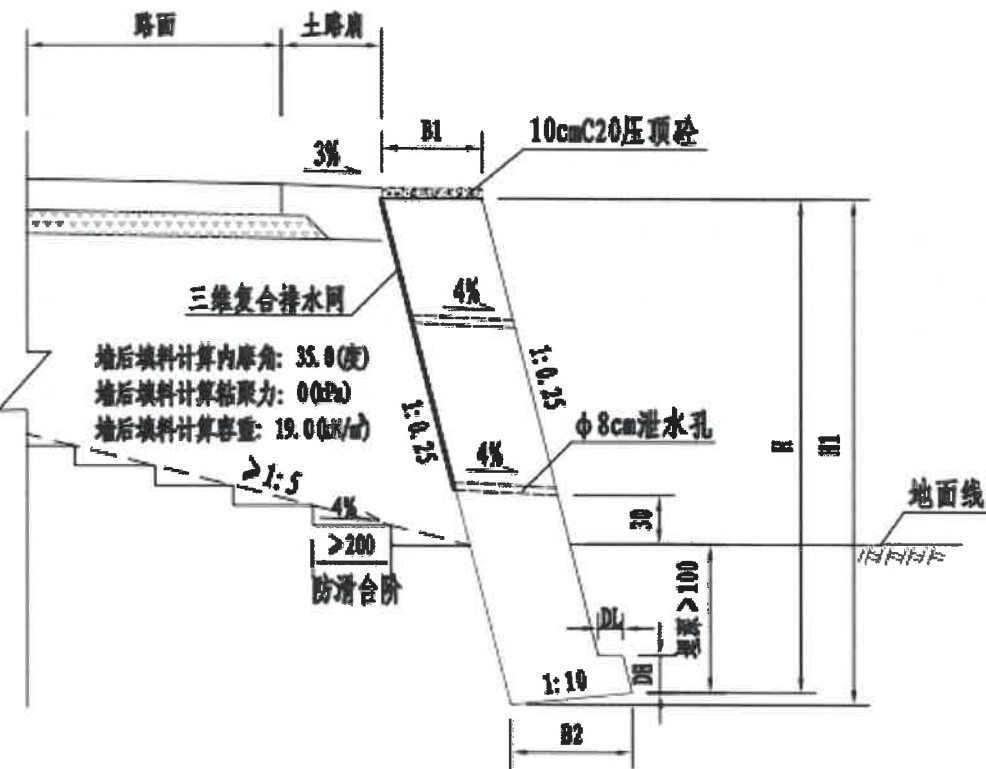
图 3.11 工点四、五、六挡土墙修复
