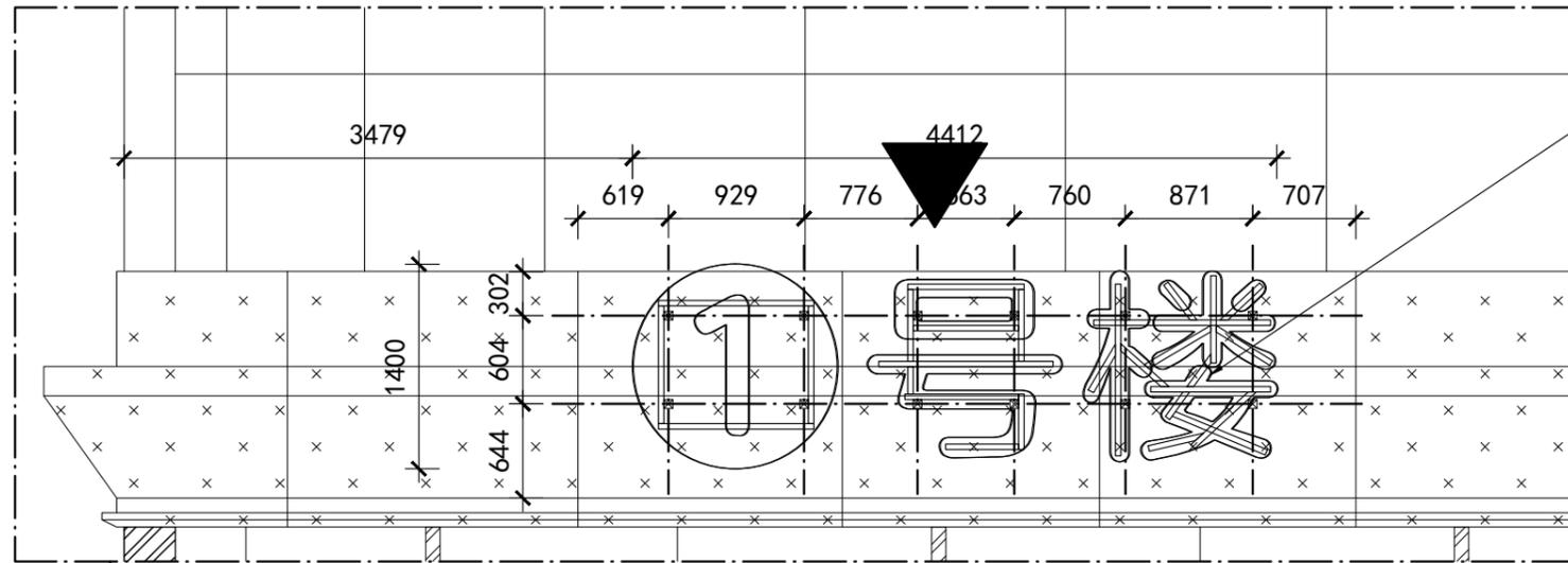
2mm铝板激光切割立体围边造型，厚度150mm，面板1.5mm不锈钢板激光切割冲孔成型，冲孔 $\phi 5$ mm，表面氟碳烤漆绿色，内衬5mm灯白亚克力板，内置LED光源模组，白天绿色，夜间正白色需配室外防水电源、电箱、时控开关(手机远程控制电源开关，4G智能系统物联网控制)和漏电保护器。
