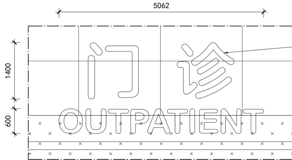
底板采用壁厚2mm铝板，激光切割，围边；面盖采用壁厚1.2mm304#不锈钢板，激光切割，围边，无缝焊接；表面抛光打磨，原子灰修补工艺缝、打磨修整、喷底漆2遍、水砂打磨、面漆红色（氟碳漆，颜色定制）3遍；内置5mm厚红色透光亚克力面板，内置防水LED光源；需配室外防水电源、电箱、时控开关（手机远程控制电源开关，4G智能系统物联网控制）和漏电保护器
