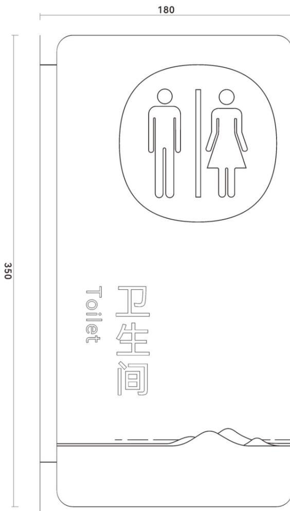
材料：1.2mm不锈钢激光切割烤箱高温烘烤、分色、内容丝印、侧装打葫芦孔
