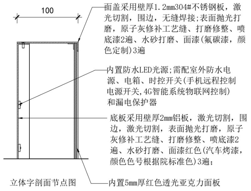
面盖采用壁厚1.2mm304#不锈钢板，激光切割，围边，无缝焊接；表面抛光打磨，原子灰修补工艺缝、打磨修整、喷底漆2遍、水砂打磨、面漆（氟碳漆，颜色定制）3遍
