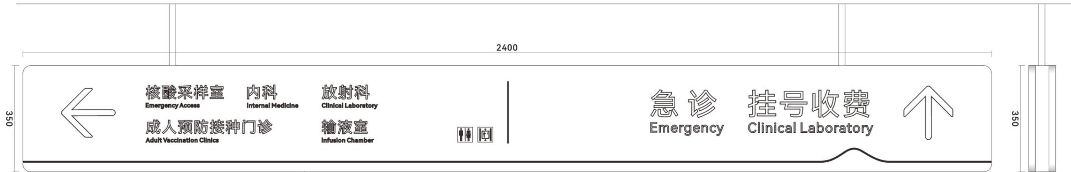
材料工艺：1.2mm不锈钢、透光膜、3mm乳白耐力板、高温烘烤、分色、内容激光镂空内衬乳白耐力板、彩色部位贴透光膜、内发光
