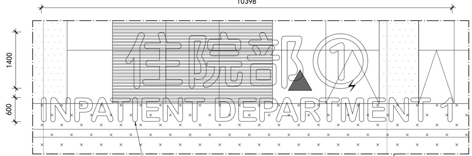
底板采用壁厚2mm铝板，激光切割，围边；面盖采用壁厚1.2mm304#不锈钢板，激光切割，围边，无缝焊接；表面抛光打磨，原子灰修补工艺缝、打磨修整、喷底漆2遍、水砂打磨、面漆（氟碳漆，颜色定制）3遍；内置5mm厚红色透光亚克力面板，内置防水LED光源；需配室外防水电源、电箱、时控开关（手机远程控制电源开关，4G智能系统物联网控制）和漏电保护器
