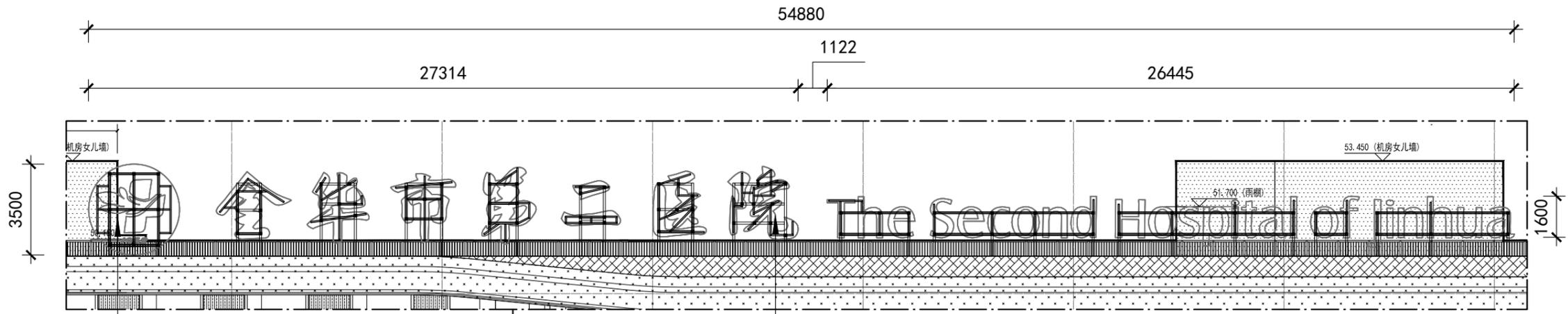
底板采用壁厚3mm铝板，激光切割，围边；面盖采用户外专用3MP刀刮布，内置防水LED模组；需配室外防水电源、电箱、时控开关和漏电保护器（背后支架需要与现场幕墙紧密连接）
