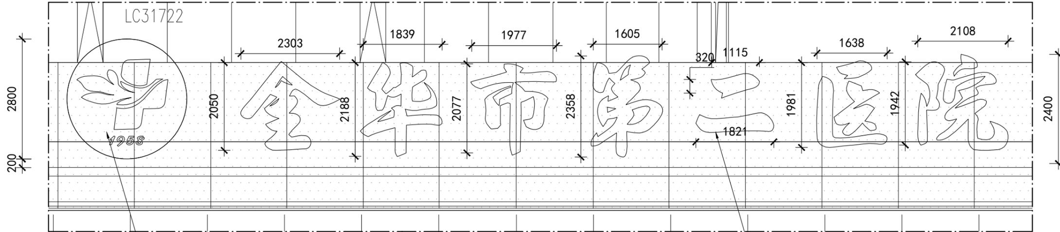
底板采用壁厚3mm铝板，激光切割，围边；面盖采用户外专用刀刮布，内置防水LED光源；需配室外防水电源、电箱、时控开关和漏电保护器（背后支架需要与现场幕墙紧密连接）需配室外防水电源、电箱、时控开关（手机远程控制电源开关，4G智能系统物联网控制）和漏电保护器。
