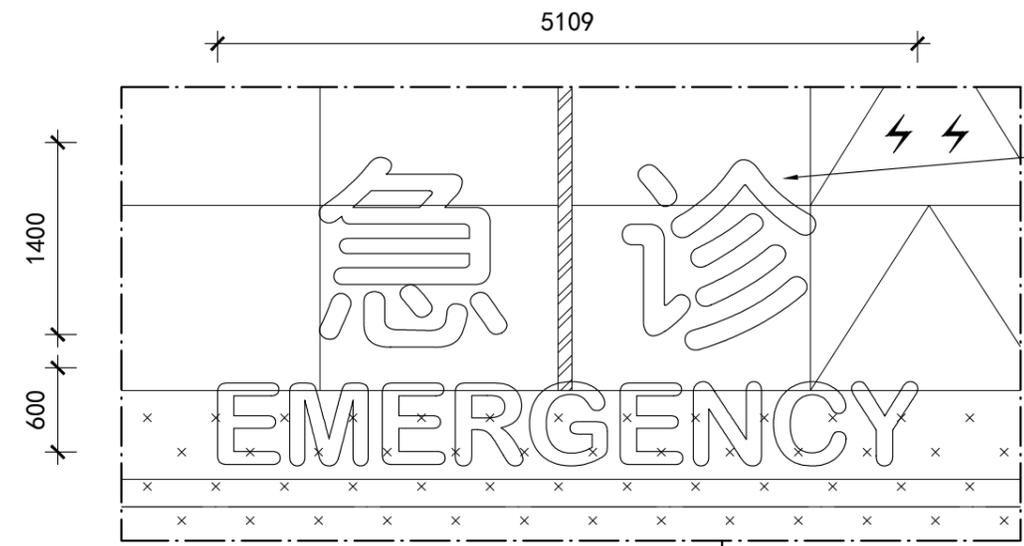
底板采用壁厚2mm铝板，激光切割，围边；面盖采用壁厚1.2mm304#不锈钢板，激光切割，围边，无缝焊接；表面抛光打磨，原子灰修补工艺缝、打磨修整、喷底漆2遍、水砂打磨、面漆红色（氟碳漆，颜色定制）3遍；内置5mm厚红色透光亚克力面板，内置防水LED光源；需配室外防水电源、电箱、时控开关（手机远程控制电源开关，4G智能系统物联网控制）和漏电保护器
