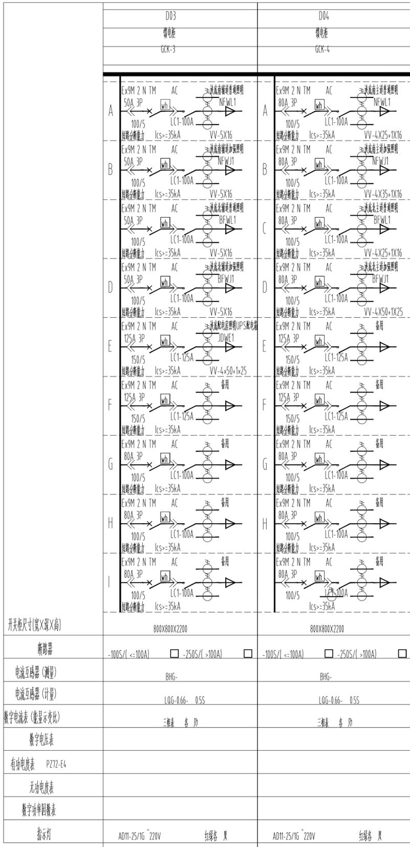
1. [wh] 为综合数字表计，带RS485通讯接口，表计支持开关量采集，开关量信号引出至表计。
