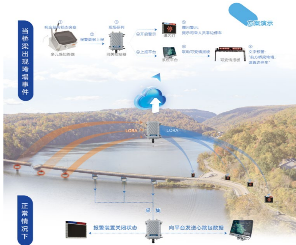
图 70 桥梁垮塌监测预报警系统架构
