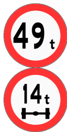
图 59 桥梁限载标志设计图
