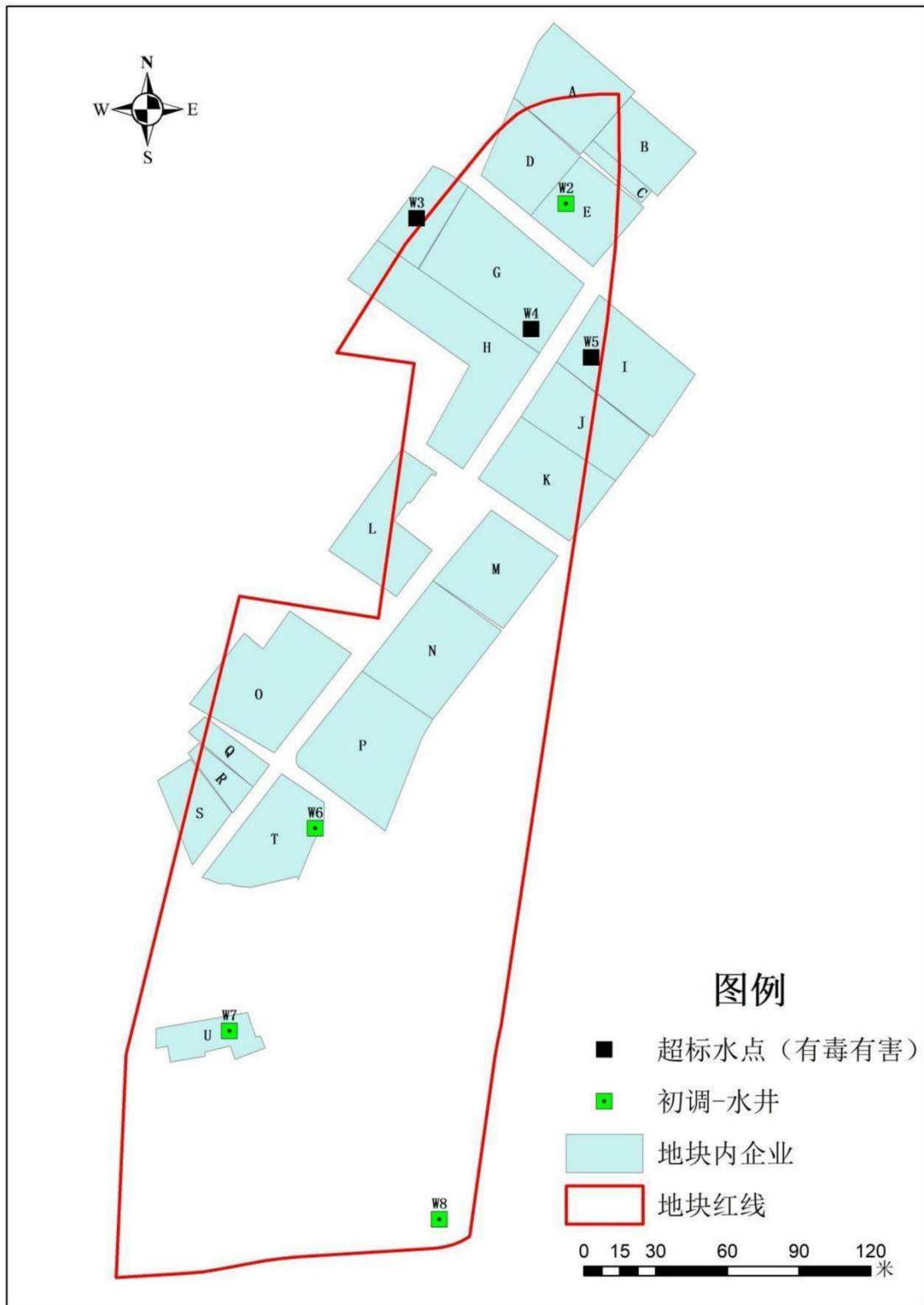
图 3.2-1 初步调查阶段有毒有害水井超标点位图
