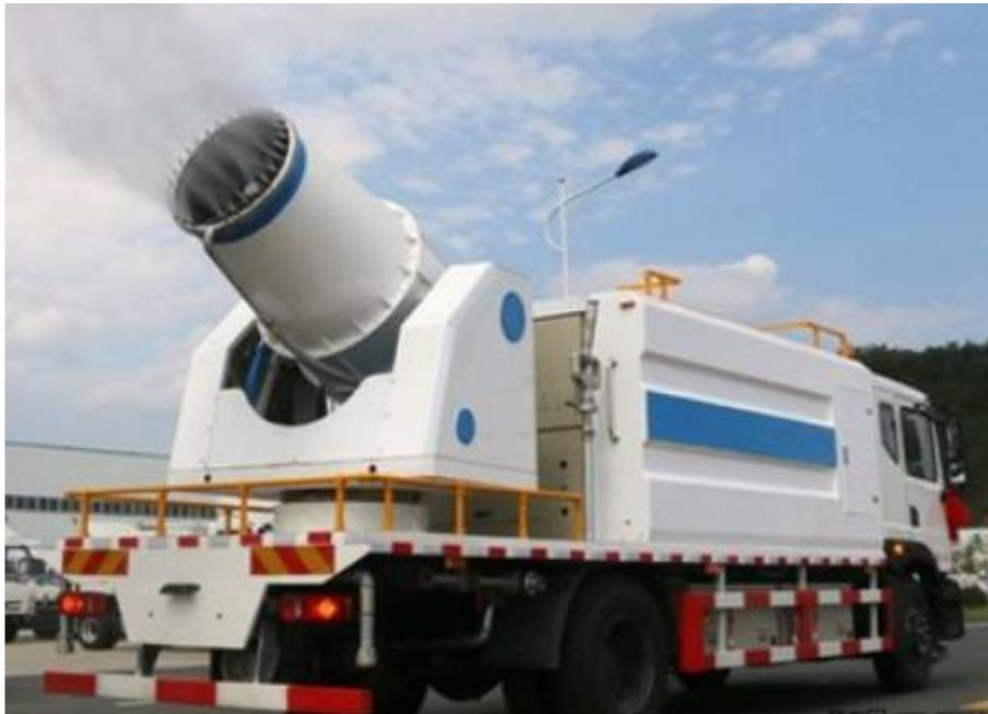
图 7.2-5 多功能抑尘车喷雾降尘
