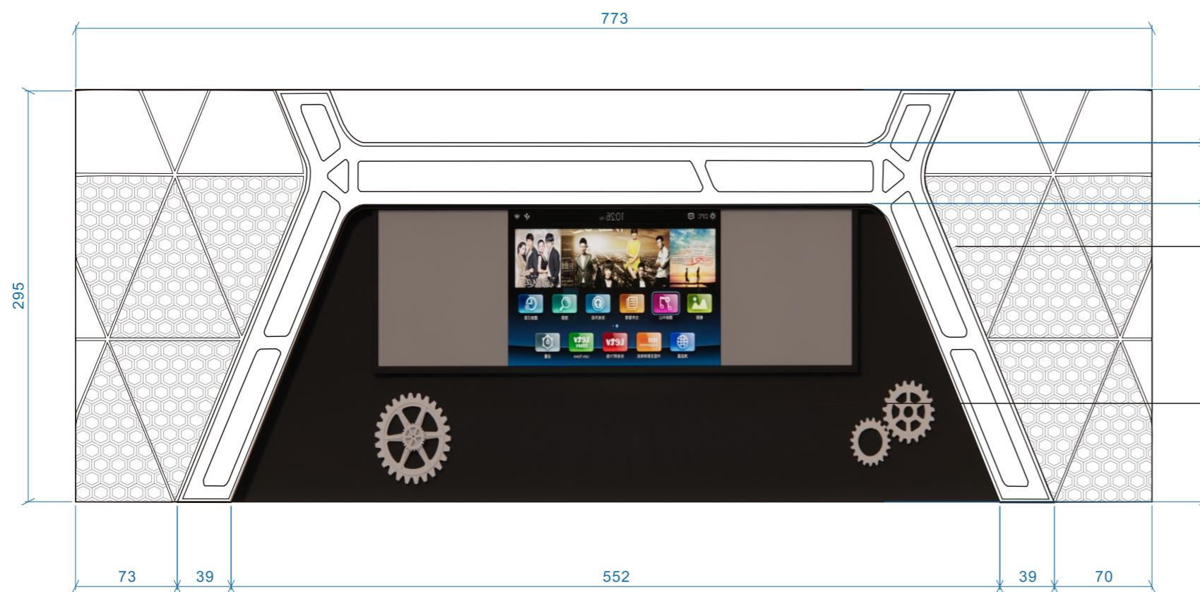
40\*40镀锌管龙骨平铺，阻燃板打底，铺设10mm石膏板造型，满刮内墙腻子打磨，刷艺术漆，刷罩光漆;背景外框部分镀锌板激光雕刻镂空造型喷汽车漆，内置LED发光灯片，发光字工艺。
