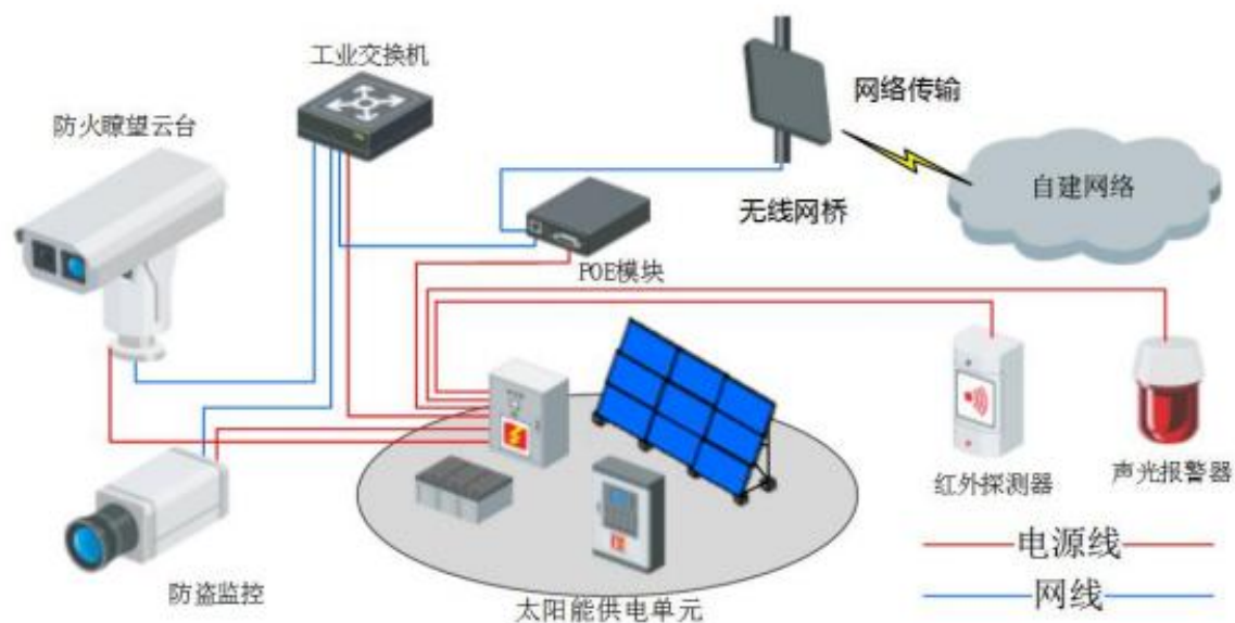
生态监测云台前端系统图
