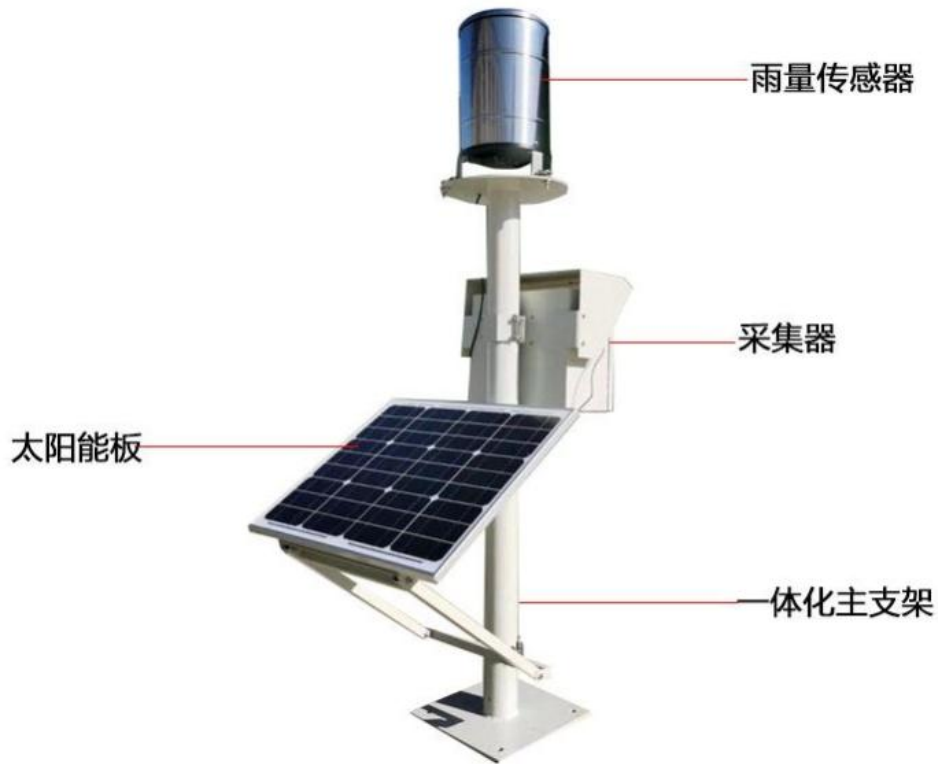
图 3.3.1-1 自动雨量站示意图
