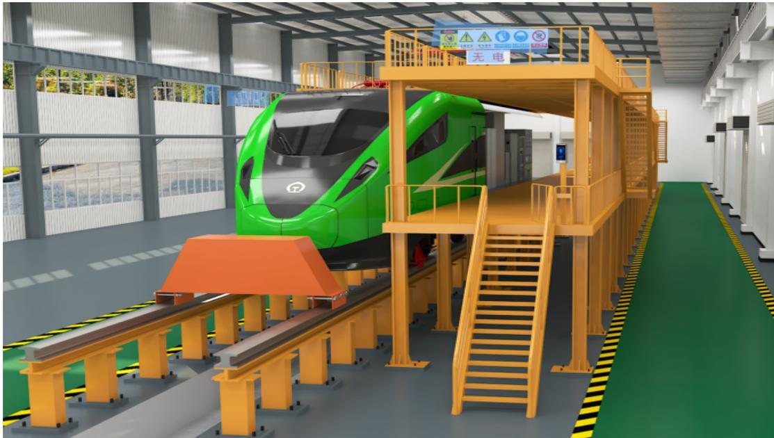
图1轨道桥及三层检修平台效果图
