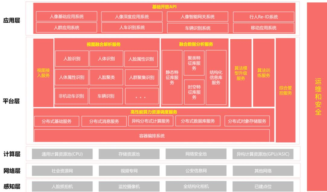
**感知层：**在图综网（原视频专网）内升级到期点位，或新建人像抓拍机、人车非全结构化相机等，通过图综网（原视频专网）统一汇聚至后端管理平台，实现以人像为核心的多维感知源的数据汇聚。可根据实际需要接入关键视频点位做结构化元素采集；实现多维新建、整合、利旧三个维度的数据大采集。
