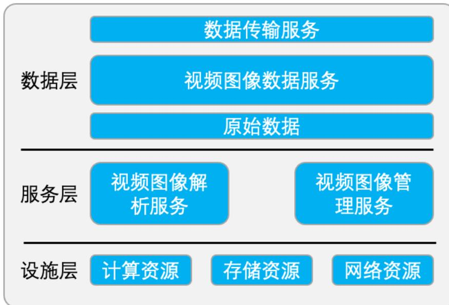
边缘节点包括设施层、服务层、数据层，提供基础设施资源管理、视频图像解析、视频图像管理、视频图像数据服务等能力。
