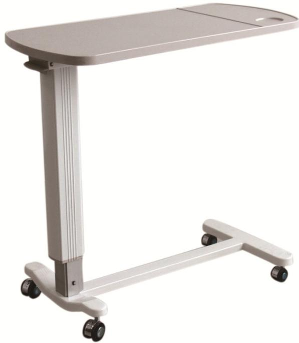
规格：820\*400\*（740-1030）mm，台面采用 ABS 工程聚塑，拉伸台面、吹塑一次性成型，易清洗，立柱、底座采用铝合金型材。单臂支撑，可升降，静音脚轮。
