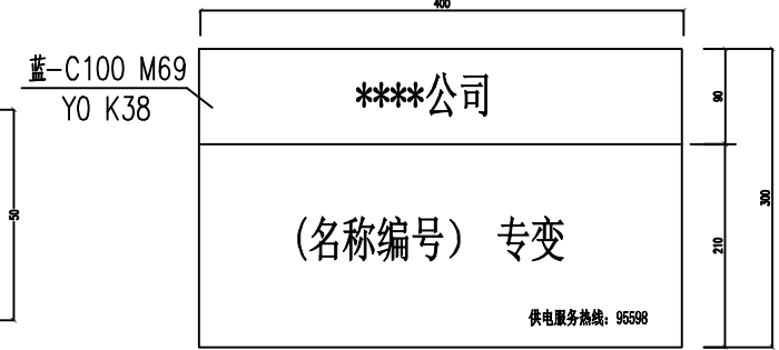
10kV箱式专变标志牌外型尺寸示意图 用于客户资产
