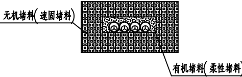
B-B 盘、柜、箱底部孔洞封堵做法
