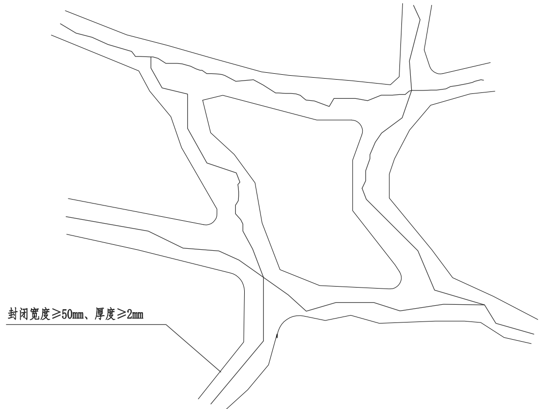
裂缝封闭示意图
