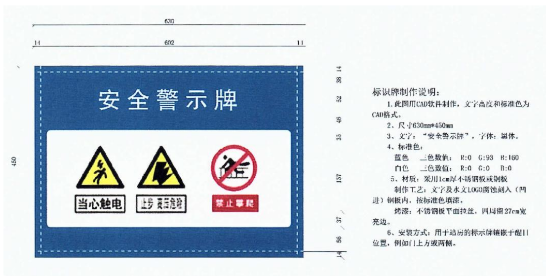
图 7.3 安全警示牌示例
