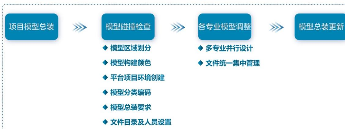
图 5.1.3-7 BIM 建模技术路线
