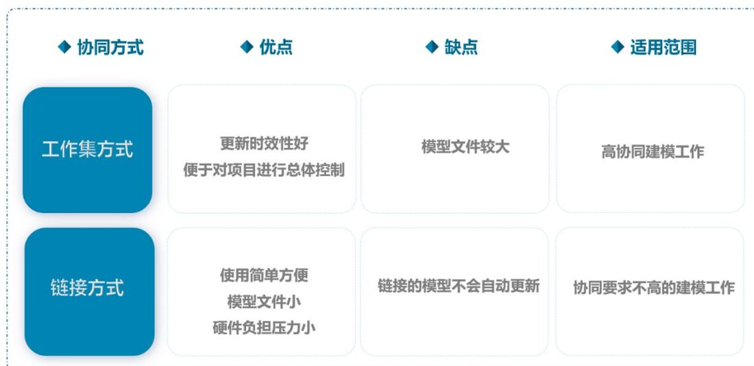
图 5.1.3-8 建模方式优缺点对比图
