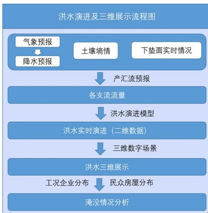
图 5.6-17 洪水演进及三维展示流程图
