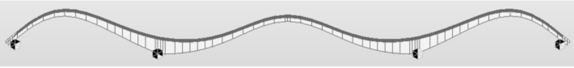
(b) 竖向 2 阶正对称挠曲振动（边跨、中跨同向，边跨半波）
