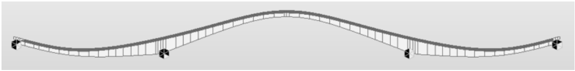
(a) 竖向 1 阶正对称挠曲振动（边跨、中跨反向，边跨半波）
