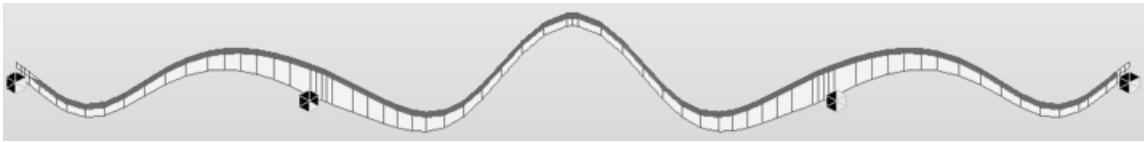
(c) 竖向 3 阶对称挠曲振动（边跨一个整波）
