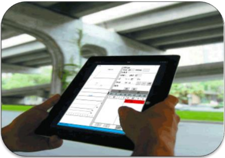
图 3-1 桥梁巡检终端子系统
