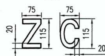
中国船检标记字母Z、C尺寸详图 1:10
