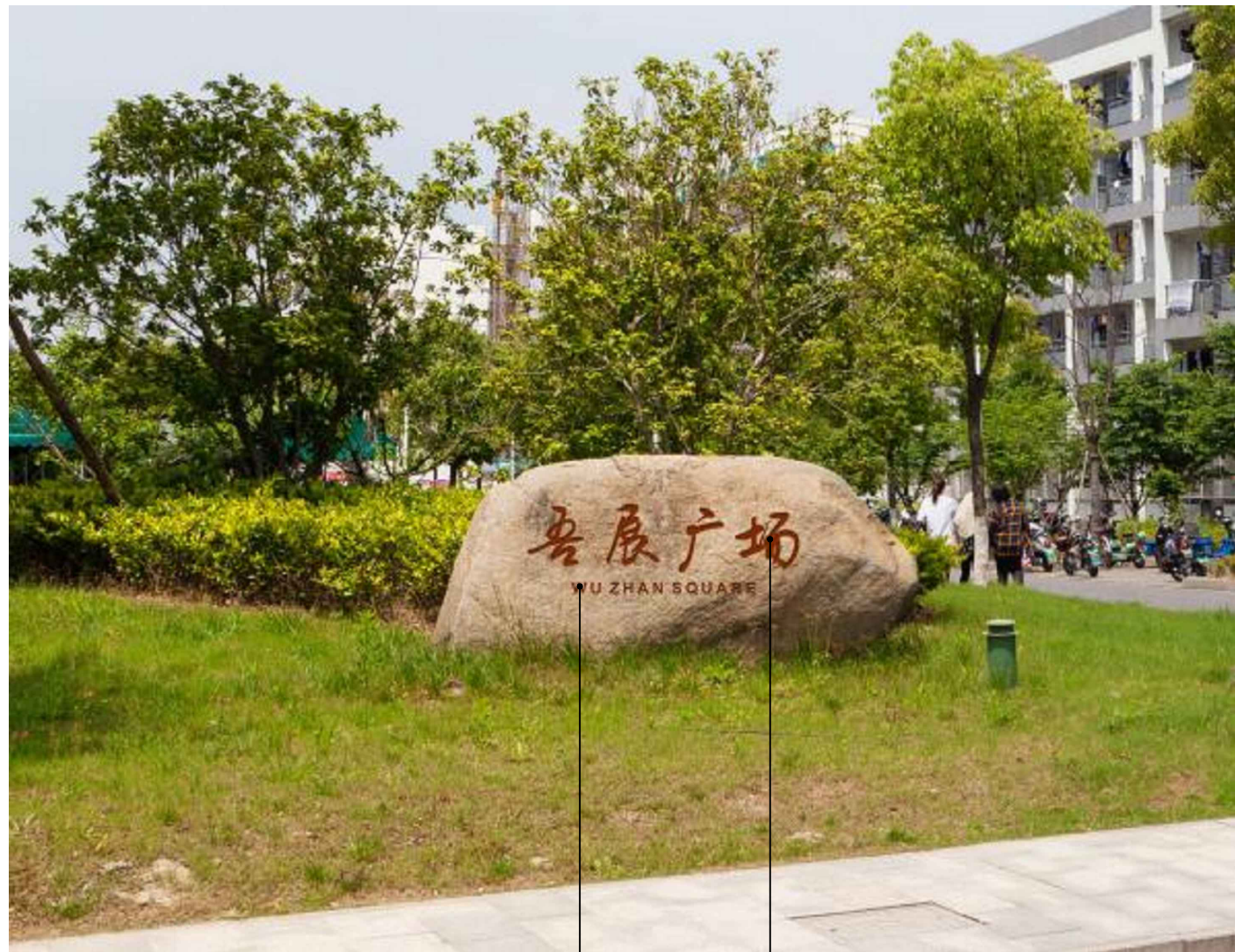
景石刻字 (阴刻10厚) 景石刻字 (阴刻10厚) 红色丙烯颜料 (字高80) 红色丙烯颜料 (字高400)
