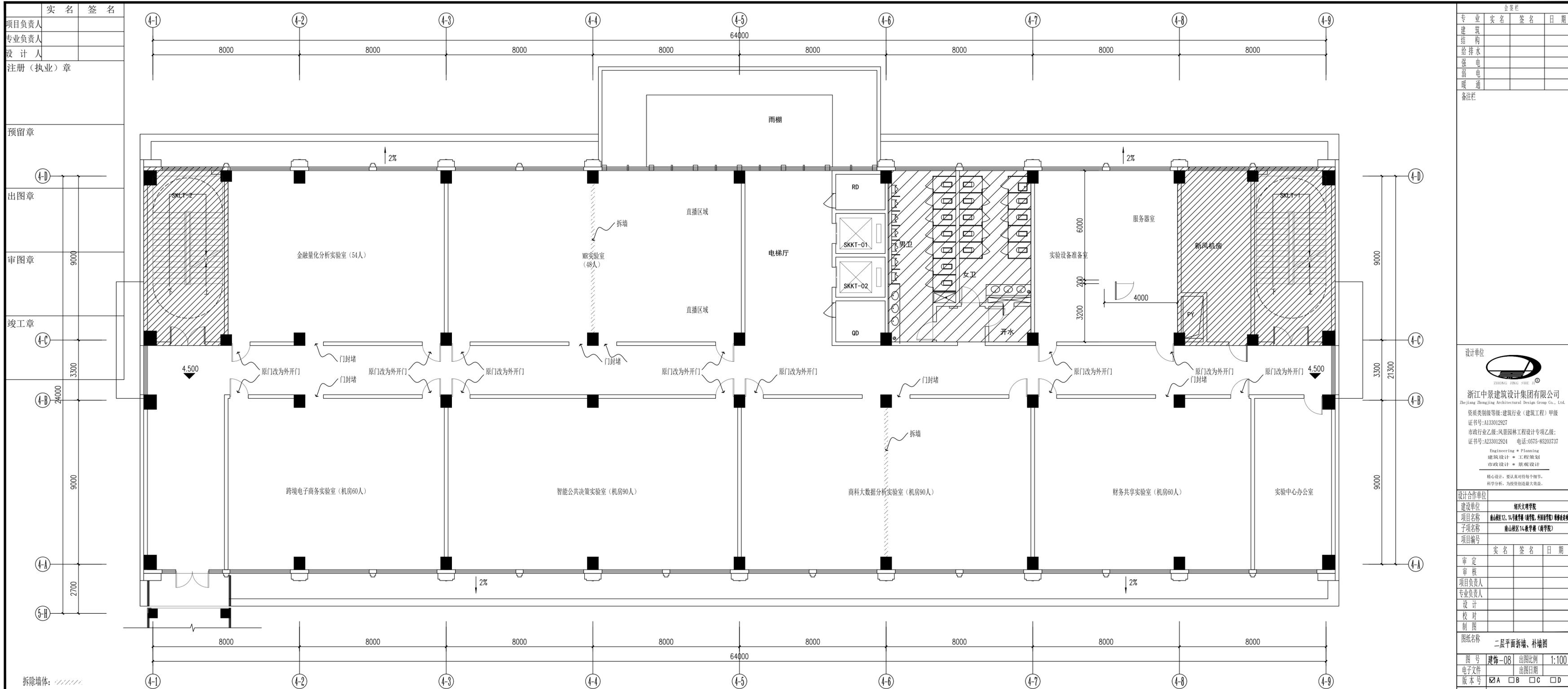
二层平面拆墙、补墙图 1:100
