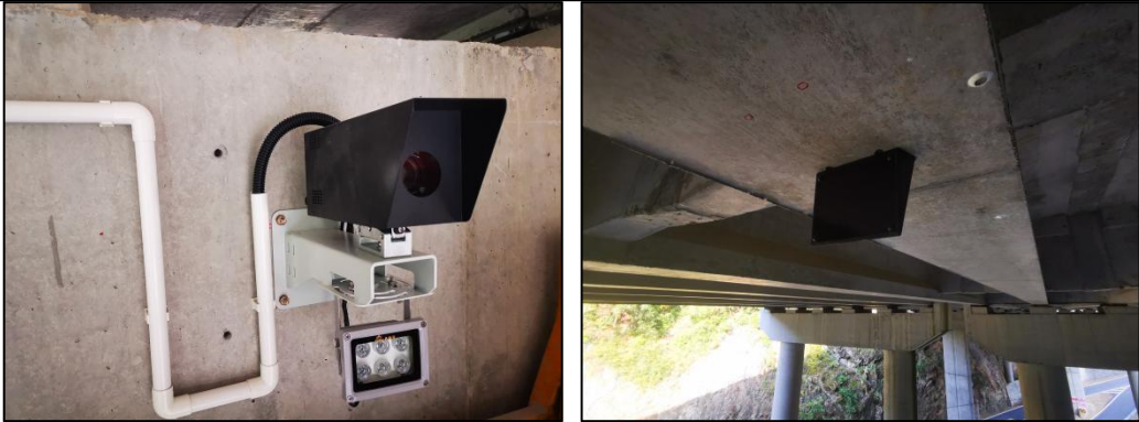
图 4.1-4 机器视觉挠度仪及靶标示例
