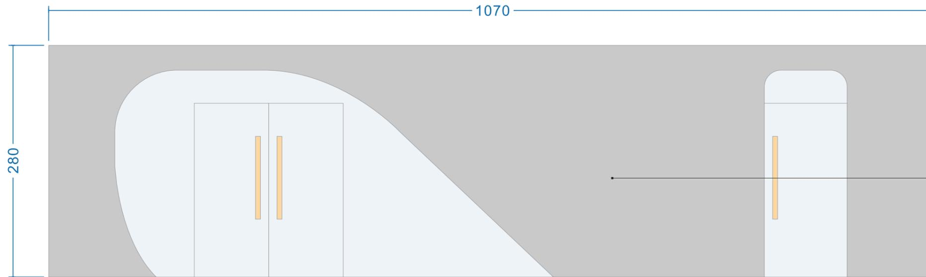
亚克力背光门牌，及电线铺设。星球元素底图精品墙绘，主题字15mm雪弗板雕刻烤漆立体字，装饰3-5mm亚克力装饰，展板铝合金磁吸展示框，实验入口弧形门开槽造型，包边收口，烤汽车漆。
