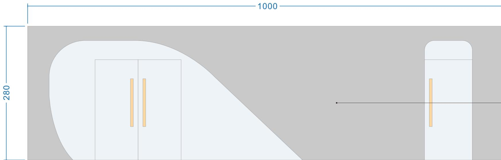
亚克力背光门牌，及电线铺设。星球元素底图精品墙绘，主题字15mm雪弗板雕刻烤漆立体字，装饰3-5mm亚克力装饰，展板铝合金磁吸展示框，实验入口弧形门开槽造型，包边收口，烤汽车漆。
