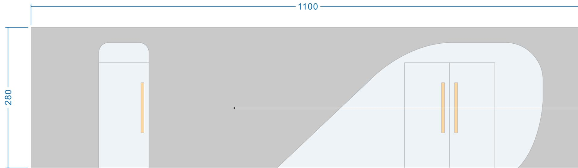
亚克力背光门牌，及电线铺设。底图中灰色内墙涂料，主题字15mm雪弗板雕刻烤漆立体字，装饰3-5mm亚克力装饰，团队展板雪弗板雕刻底贴软磁板，画面换得易UV数码打印，实验入口弧形门开槽造型，包边收口，烤汽车漆。
