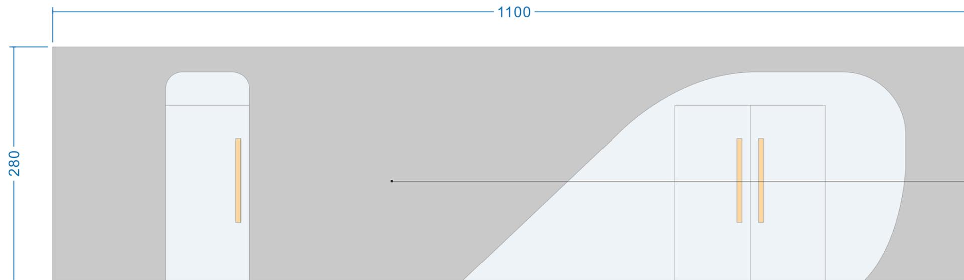
亚克力背光门牌，及电线铺设。星球元素底图精品墙绘，主题字15mm雪弗板雕刻烤漆立体字，装饰3-5mm亚克力装饰，展板铝合金磁吸展示框，实验入口弧形门开槽造型，包边收口，烤汽车漆。
