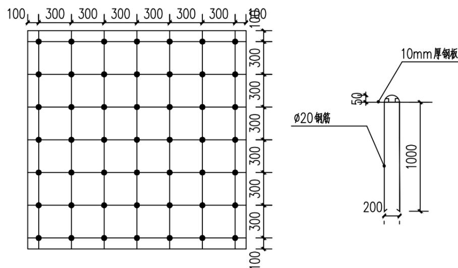
**2** 主装置底部基础配筋图
