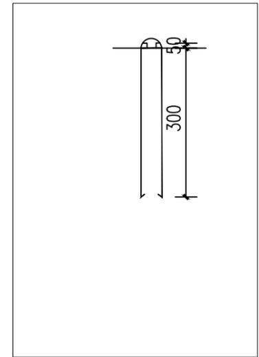
③ 立柱底部钢筋预埋件
