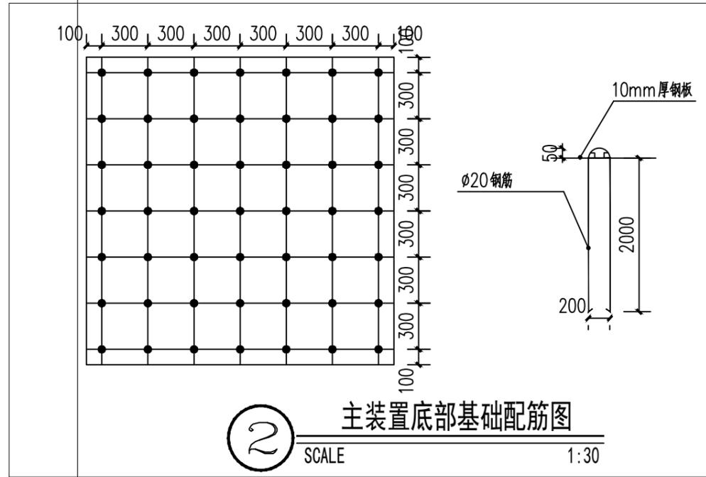
② 主装置底部基础配筋图
