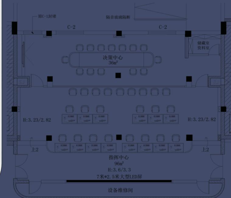
鹿西智管中心（指挥中心部分）设计说明：本案区域为指挥中心、决策中心（会议室）、设备维修间、档案资料室。针对空间需求的特点，将先进的金属加工工艺、钢琴烤漆工艺、人体工程学完美地结合在指挥中心控制台、调度台等产品之中。使指挥中心对突发事件现场情况和处置进程能够实时掌握和控制,实现高效可靠指挥。
