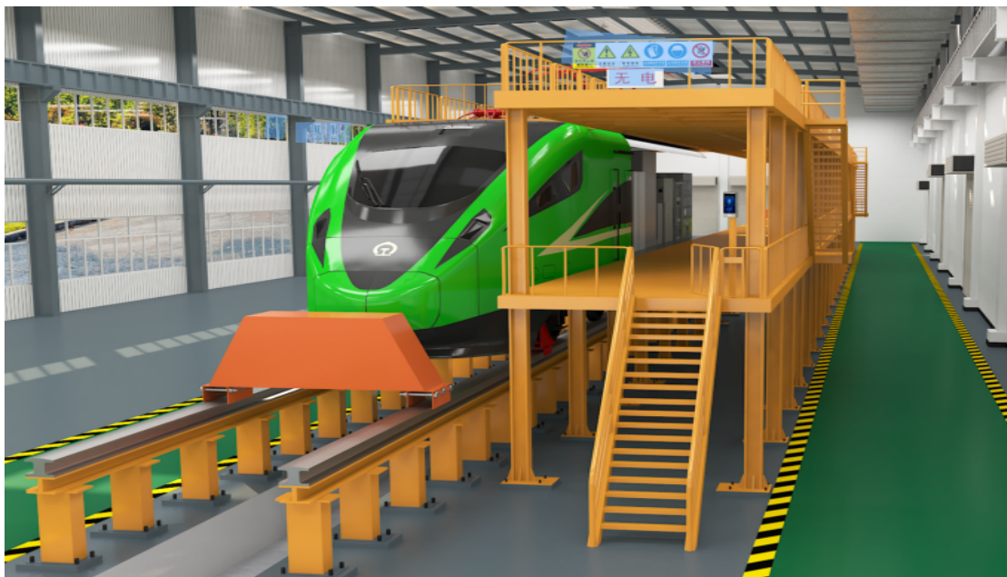
图1轨道桥及三层检修平台效果图
