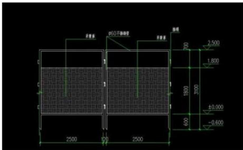
首先取两个围栏单片，选定一角，沿定位绳外测呈 90 度角 放立后，用连接卡扣上下固定，按以上连接固定方式，向两侧延伸安装，每两片围栏单片之间用折叠支架和螺旋地桩连接固定。四面各安装围栏单片（圈门安装在事先选定的位置），移动羊圈 由 厂家组织技术人员指导安装。
