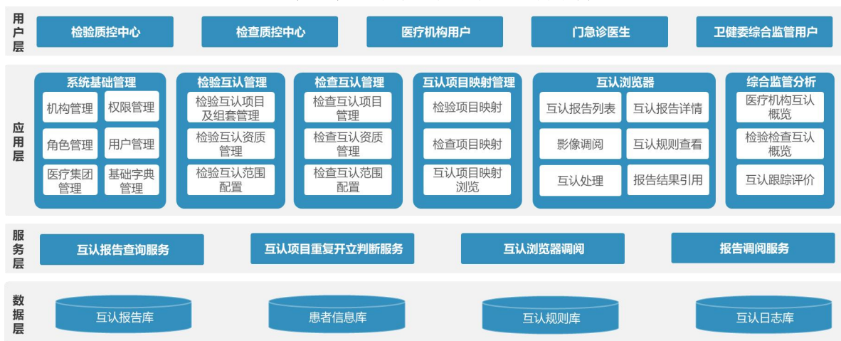
检查检验结果互认系统的逻辑结构
