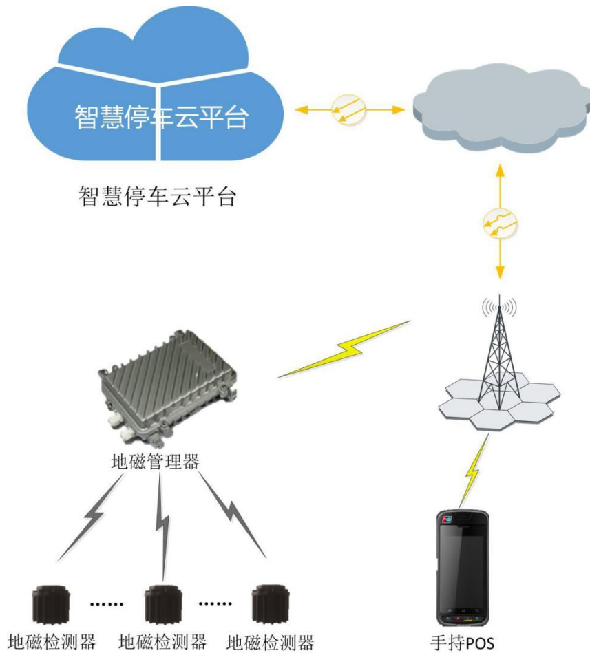
图 -1 地磁停车场管理系统构成图
