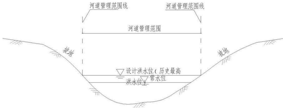
图 4-2 无堤防的河道划界示意图
