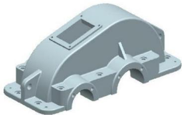
(6) ◆减速器下箱体零件的造型，如下图所示，视频时长不少于 10 分钟。
