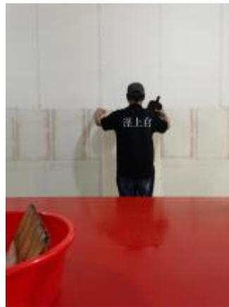
③研光。先施蜡后用大号研石进行粗研，使纸张密实，后用材质细密的研光工具提光。
