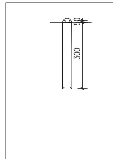
③ 立柱底部钢筋预埋件
