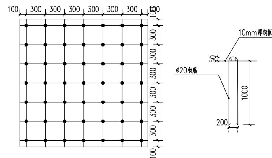
② 主装置底部基础配筋图
